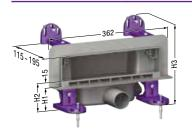
H1 = Upper edge flange 65 - 200 mm H2 = Upper edge tile 80 - 215 mm H3 = Overall height 218 - 353 mm
